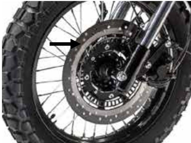
Le contrôle des garnitures se limite pour l'essentiel à la vérification de leur état d'usure par comparaison de leur épaisseur avec la rainure formant repère. La garniture doit être remplacée si elle est usée jusqu'au fond de la rainure.
