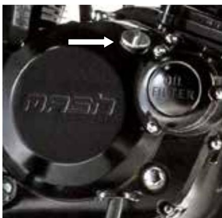
3. Retirer le bouchon de vidange du couvercle de la crépine (en dessous du moteur) pour effectuer la vidange.
