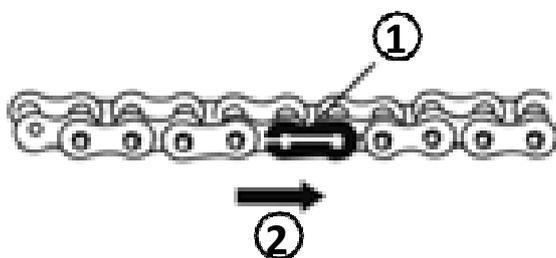
1. Clip d'attache rapide de la chaîne 2. Sens de rotation
