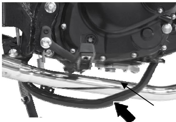
Appuyer sur cette pédale pour actionner le frein : le témoin de freinage s'allume simultanément.
