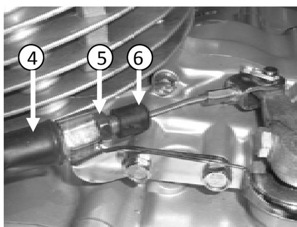
Desserrer l'écrou (1) et tourner à fond l'anneau de tension du levier (2) dans le sens horaire. Dévisser le contre-écrou de l'anneau de tension du câble (5), avant de tourner l'anneau (4) dans un sens puis dans l'autre jusqu'à ce que le jeu du levier atteigne environ 4 mm. L'anneau de réglage du levier (2) peut éventuellement servir à affiner le réglage. Une fois le réglage effectué, resserrer le contre-écrou (1) et l'anneau (5), puis les envelopper avec le manchon en caoutchouc (3).
