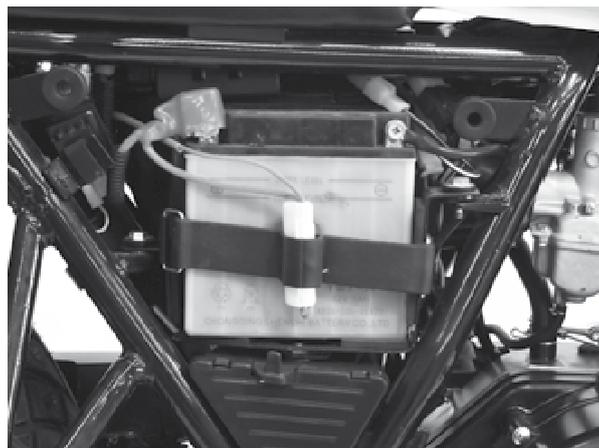
Le boîtier à fusible se situe en dessous du carénage latéral droit. Un seul fusible assure la protection de l'ensemble du circuit électrique. En cas de défaillance de ce dernier, commencer par vérifier si le fusible n'est pas grillé. Dans ce cas, le remplacer par un fusible de rechange (15A) fourni dans le boîtier prévu à cet effet.
