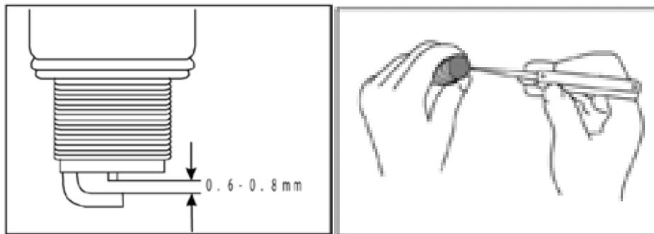
Après avoir parcouru les 1000 premiers kilomètres, puis tous les 5000 km, nettoyer les dépôts de calamine présents sur la bougie en se servant d'une petite brosse métallique ou d'un nettoyeur de bougie. À l'aide d'une jauge d'épaisseur, régler l'écartement des électrodes en conservant une valeur comprise entre 0,6 et 0,8 mm. Remplacer la bougie tous les 5000 km.
