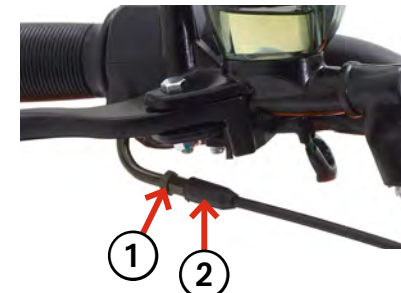
1. Contre-écrou 2. Ecrou de réglage
