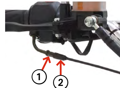
1. Contre-écrou 2. Ecrou de réglage
