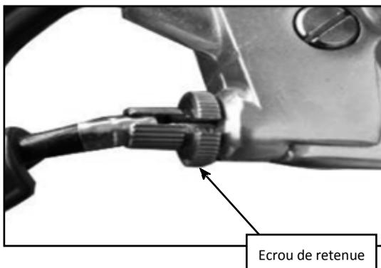
Enlever le câble d'embrayage sur le bout de la poignée, puis retirez le bras d'embrayage sur le moteur; tourner le bras d'embrayage selon un certain angle et le remonter, puis remettre le câble d'embrayage sur la poignée, enfin ajuster à une garde satisfaisante selon le réglage idéal.
