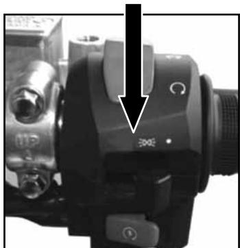
L'indicateur de position montre sa position aux véhicules à proximité et signale sa présence aux véhicules à un croisement.
