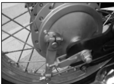
Dévisser l'écrou de l'axe de la roue arrière
