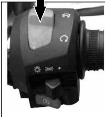
***Pendant la conduite, tourner l'interrupteur de (↻) à (⊗) est dangereux et endommagera le moteur. avant d'utiliser l'interrupteur d'arrêt d'urgence pour arrêter le moteur, assurez-vous que l'interrupteur principal soit en position (↻) s'il est en position (⊗) position et que le moteur est coupé, la batterie se déchargera. si l'interrupteur est en position (⊗), vous ne pourrez pas démarrer le moteur.***
