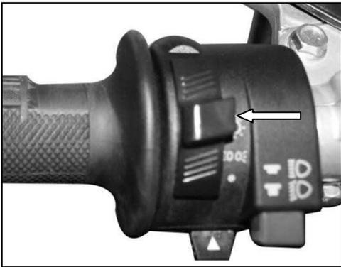
L'indicateur de feux de position indique la position de la moto aux véhicules à proximité et signale sa présence aux véhicules à un croisement
