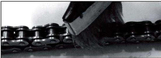
Nettoyer et appliquer de la graisse à chaîne spéciale joints toriques
