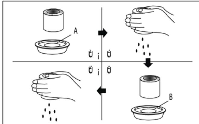
1. Remplir un récipient de taille adaptée d'une solution de nettoyage incombustible. Immerger la mousse dans la solution de nettoyage, puis la rincer.
