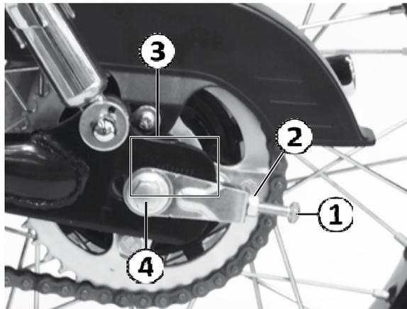
1. Boulon de réglage 2. Contre-écrou
