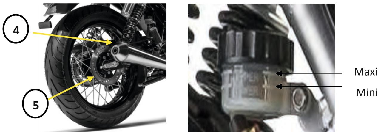
Dégraissier à intervalle régulier le disque de frein arrière (5) afin de garantir une qualité de freinage optimale en permanence.
