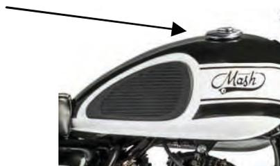
Pour ouvrir le bouchon du réservoir, insérer la clé et la tourner dans le sens horaire. Le bouchon peut alors être retiré avec la clé. Pour remettre le bouchon en place, aligner les flèches figurant respectivement sur le bouchon et sur le réservoir, puis, la clé étant enfoncée, exercer une pression sur le bouchon jusqu'à ce qu'un déclic se fasse entendre. Retirer ensuite la clé :
