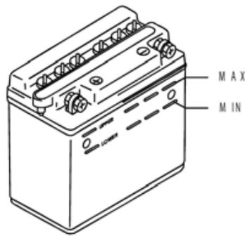
Avant toute utilisation, remplir la batterie d'électrolyte entre les repères de niveau supérieur et inférieur. Durant la période d'utilisation de la motocyclette, veiller à ce que le niveau reste entre ces deux repères.
