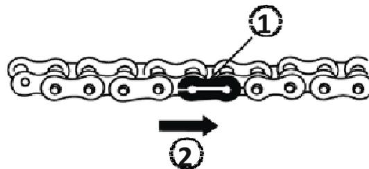
1. Clip d'attache rapide de la chaîne 2. Sens de rotation
