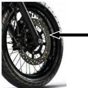
Le contrôle des garnitures se limite pour l'essentiel à la vérification de leur état d'usure par comparaison de leur épaisseur avec la rainure formant repère. La garniture doit être remplacée si elle est usée jusqu'au fond de la rainure.
