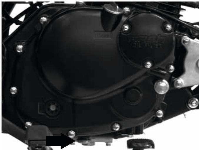
4. Serrer la vis de vidange et remplir le réservoir d'huile en y ajoutant la quantité d'huile nécessaire, avant de resserrer doucement le bouchon supérieur.
