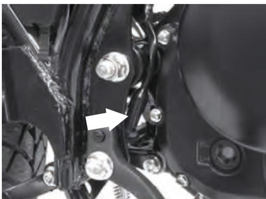
Le contacteur du feu stop arrière se situe sur le côté droit de la motocyclette. Pour régler le contacteur du feu stop arrière, procéder comme suit : Soulever ou abaisser le contacteur de sorte que le feu s'allume à la moindre pression sur la pédale de frein.
