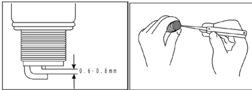
Après avoir parcouru les 1000 premiers kilomètres, puis tous les 3000 km, nettoyer les dépôts de calamine présents sur la bougie en se servant d'une petite brosse métallique ou d'un nettoyeur de bougie. A l'aide d'une jauge d'épaisseur, régler l'écartement des électrodes en conservant une valeur comprise entre 0,6 et 0,8 mm. Remplacer la bougie tous les 6000 km.
