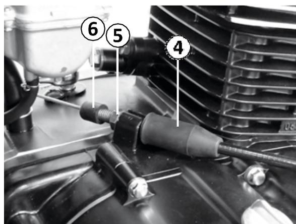
Desserrer l'écrou (1) et tourner à fond l'anneau de tension du levier (2) dans le sens horaire. Dévisser le contre-écrou de l'anneau de tension du câble (5), avant de tourner l'anneau (4) dans un sens puis dans l'autre jusqu'à ce que le jeu du levier atteigne environ 4 mm. L'anneau de réglage du levier (2) peut éventuellement servir à affiner le réglage. Une fois le réglage effectué, resserrer le contre-écrou (1) et l'anneau (5), puis les envelopper avec le manchon en caoutchouc (3).
